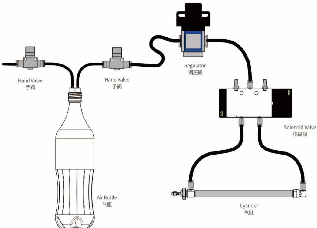
图 4.3-1 单缸气动装置的标准连线图
