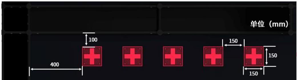
图 3.3-9 报告打印区尺寸图
